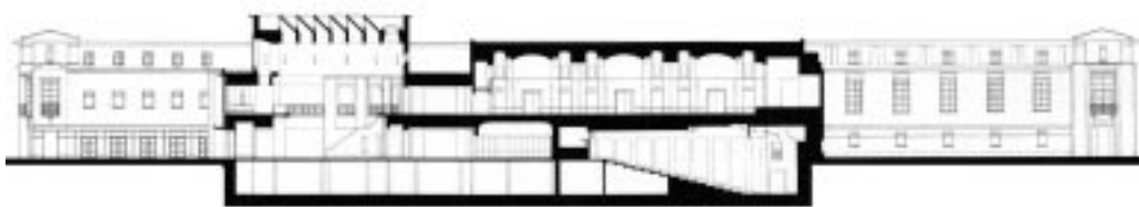
Sezione nord-sud del Centro Comunitario in corrispondenza del foyer (che costituisce la parte sinistra del volume sezionato). Il vano sezionato in alto a destra è quello della sala da ballo. Quello in basso a destra è quello dell' auditorium .
