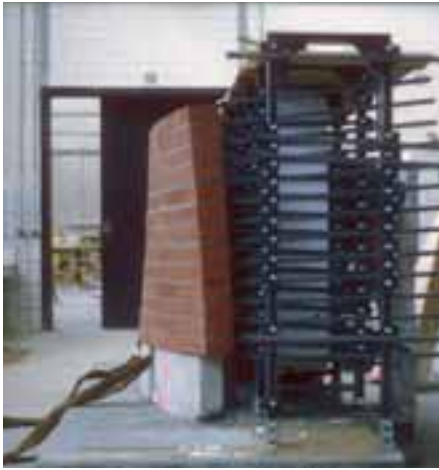
Secondo prototipo con superfici di muratura a doppia curvatura negativa (a sella), progettato da Speth come copertura della Lower Saxony Building Industry Confederation. L'esilità della struttura permette di coglierne da tutti i punti di vista l'andamento curvilineo.
