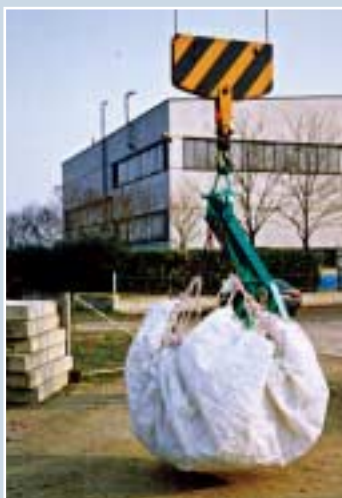
Fig. 8 - Esempio di sollevamento di laterizi con forca e sacchi di imbracco del carico (produzione Tecnobrevetti).
