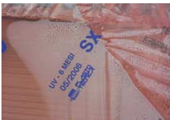
Fig. 3 - Pacco di laterizi, confezionato con involucro in termoretraibile, sul quale è indicata la data di confezionamento e la durata ammessa per l'esposizione ai raggi ultra violetti (il disegno è tratto dal volume "La realizzazione di murature in laterizio" di Norberto Tubi).
