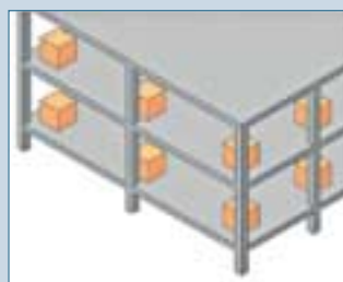
Fig. 11 - Corretta sistemazione dei pacchi di laterizio sui solai.
