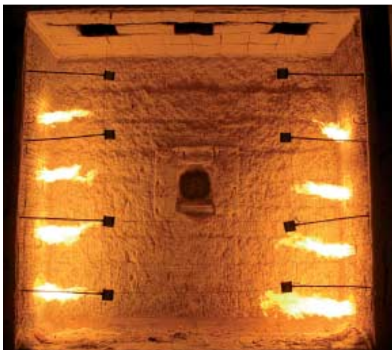
Fig. 7 - Forno sperimentale a bocca verticale.
