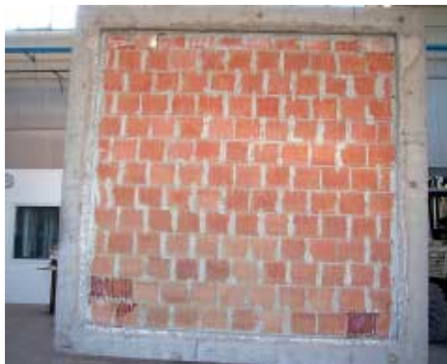
Fig. 2 - Parete non intonacata: faccia esposta al fuoco dopo la prova.
