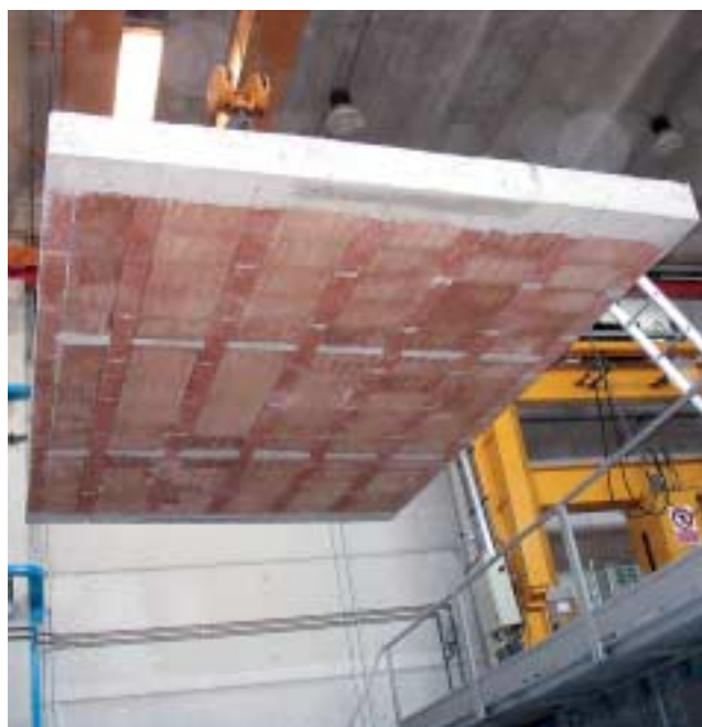
Fig. 5 - Montaggio di un solaio su forno sperimentale a bocca orizzontale.
