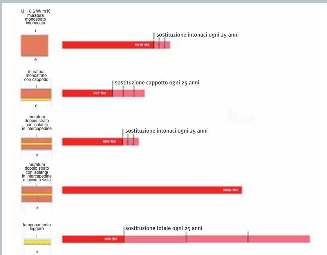
9. Valutazione dell'energia incorporata (in rosso) in relazione a diverse soluzioni di involucro, a parità di trasmittanza termica. In rosso chiaro è indicata l'energia incorporata aggiuntiva imputabile agli interventi di manutenzione, considerando un arco temporale di 100 anni (se si tiene conto del ciclo di vita di un edificio, il valore dell'energia incorporata aumenta nel tempo in relazione agli interventi di manutenzione).
