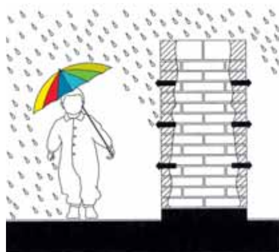
Addensamento di sali verso la superficie esterna di una muratura.
