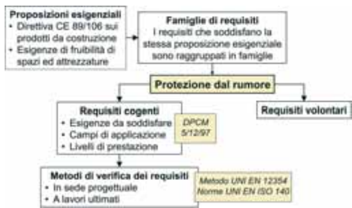
2. Schema di attuazione e verifica dei requisiti tecnici per la protezione dal rumore negli edifici.
